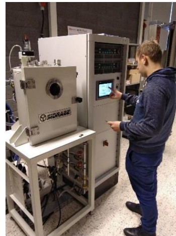
Darbs ar vakuumuzputināšanas iekārtu un cietības mērītājiem (Rockwell; Brinell; Vickers; Shore A, D)
