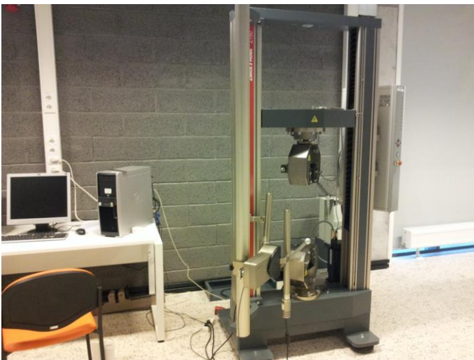
Materiālu testēšanas laboratorija: universālā stiepes mašīna (stiepe, spiede, liece, šļūde, cikliski sloģojumi u.c.)
