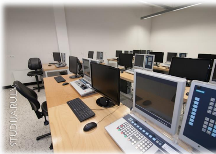
CAD/ CAE/ CAM laboratorija: konstruēšana (SolidWorks), datorizētie inženieraprēķini (SW Simulation, Comsol, MatLab), CNC darbgaldu programmēšana (Sinumerik 840D, Heidenhein TNC430, Fanuc 21), CAM tehnoloģijas (MasterCam)
