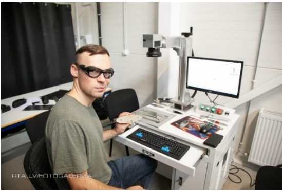
Viena no darba vietām virsmas funkcionālai lāzerteksturēšanai
