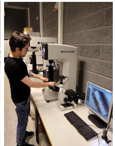
Darbs ar vakuumuzputināšanas iekārtu un cietības mērītājiem (Rockwell; Brinell; Vickers; Shore A, D)
